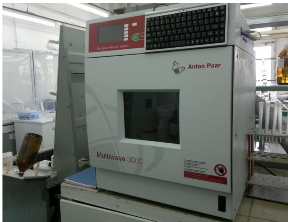
Rysunek 17. Mineralizator mikrofalowy Multiwave 3000 firmy Anton Paar – do mineralizacji mikrofalowej osadów w stężonych kwasach
