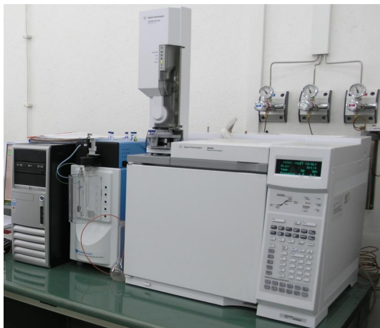
Rysunek 14. Chromatograf gazowy 6890N firmy Agilent Technologies z detektorem płomieniowo-jonizacyjnym (FID), detektorem wychwytu elektron (ECD) i przystawką PT (Purge and Trap), do oznaczeń substancji organicznych
