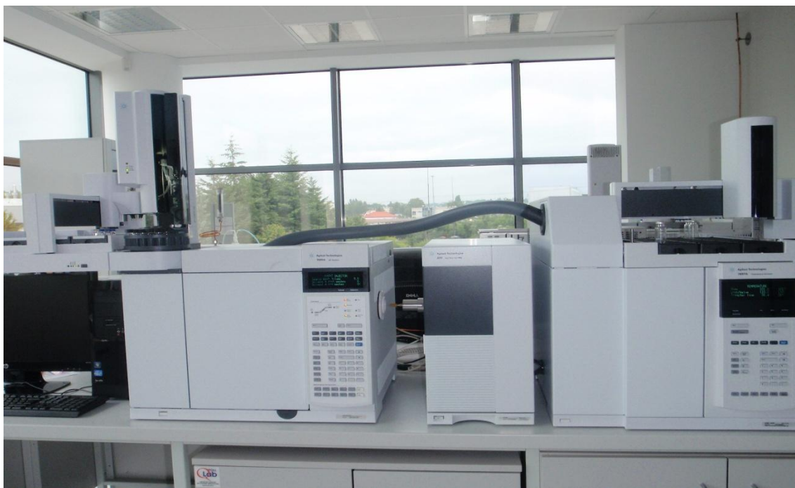
Rysunek 16. Chromatograf gazowy ze spektrometrem mas (GC-MS - pułapka jonowa) 7890A/220lon Trap/HSP 7697A firmy Agilent Technologies - do oznaczeń substancji organicznych
