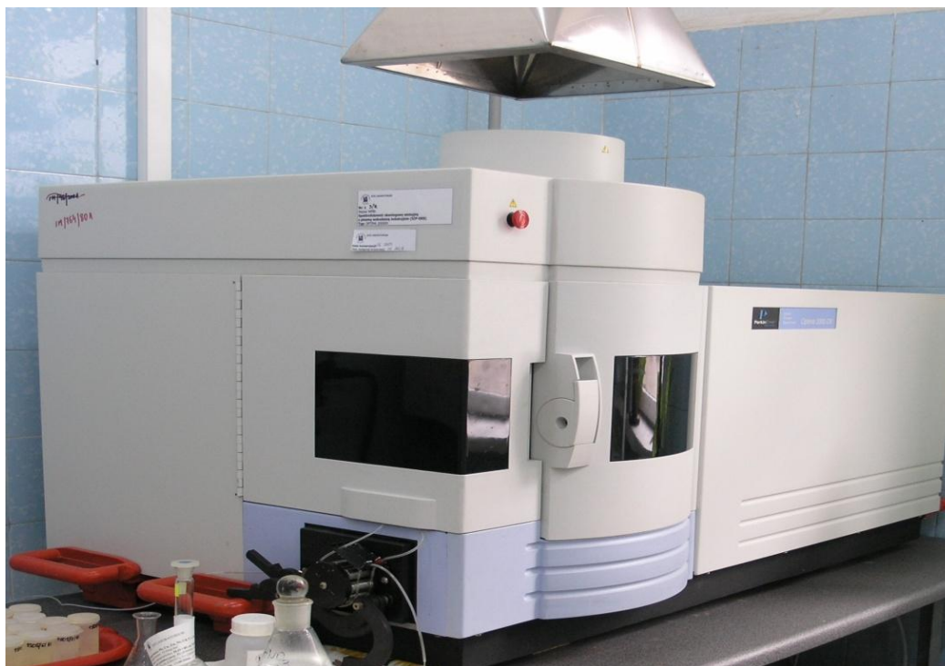
Rysunek 18. Spektrometr emisyjny z plazmą wzbudzoną indukcyjnie OPTIMA 2000DV firmy PRERKIN-ELMER (oznaczanie metali)
