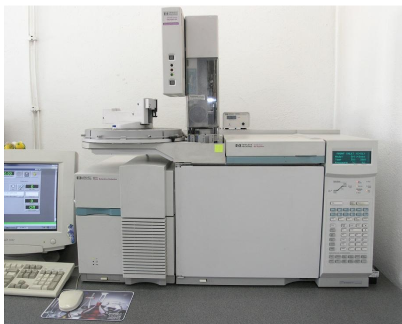
Rysunek 15. Chromatograf gazowy ze spektrometrem mas (GC-MS) firmy Hewlett Packard do oznaczeń substancji organicznych
